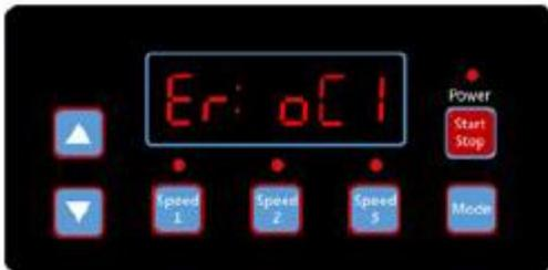
(Diagramm 6.8 Fehler, Fehlercode OC1)
