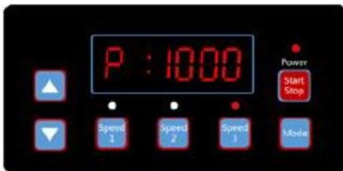
(Diagramm 6.9, Anzeige der Leistungsaufnahme, Stufe 3)
