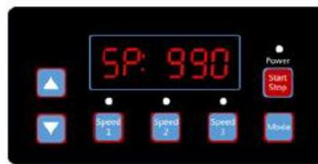
(Diagramm 6.10, 1000 U/min einmal "Oben" drücken) (Diagramm 6.11, 1000 U/min einmal "Unten" drücken)
