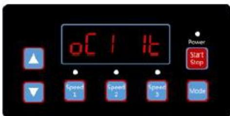
(Diagramm 6.25, Auto-Wiederherstellung, Fehlerangabe OC1, Fehlerzeit 1)
