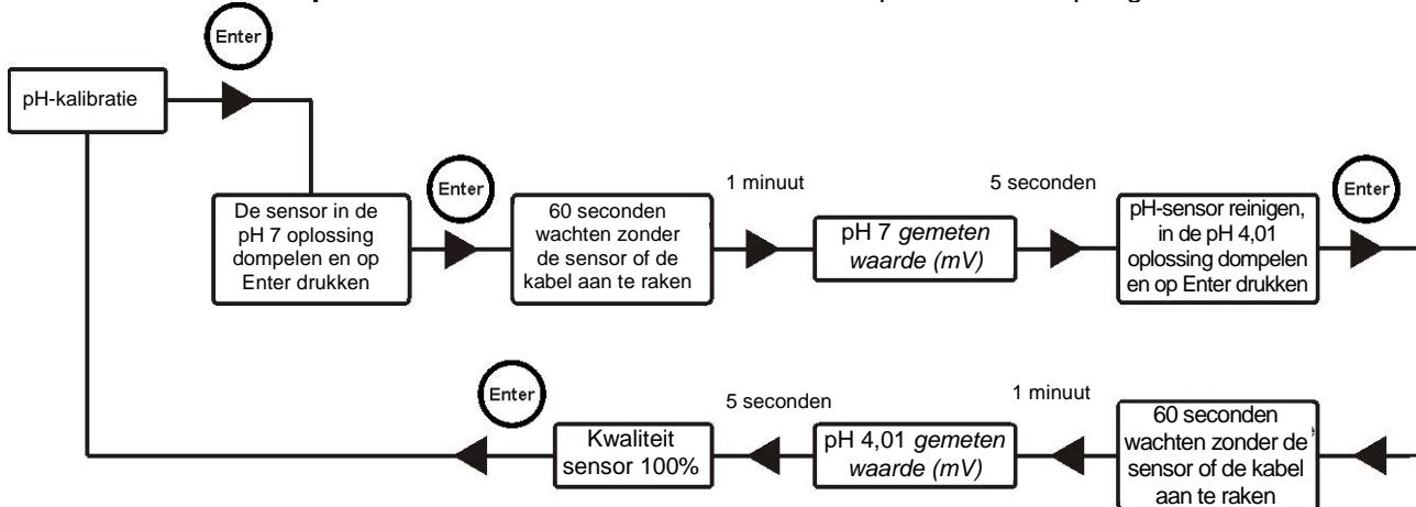
**Na het verrichten van de pH 7-kalibratie, moet de elektrode met water worden afgespoeld om te voorkomen dat de pH 4-oplossing wordt vervuild.**
