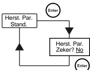
Het herstellen van de fabrieksinstellingen wordt ingeschakeld (zie bijlage 1) en het systeem vraagt of u er zeker van bent om door te gaan.
