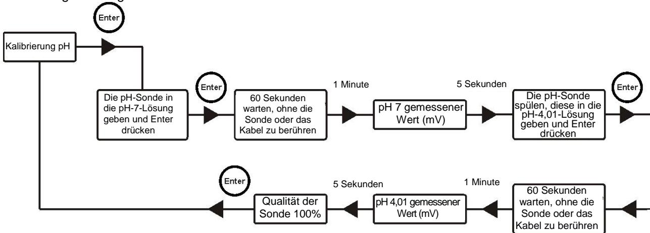
**Nach der Kalibrierung des pH 7, die Elektrode mit Wasser spülen, sodass die pH-4-Lösung nicht verunreinigt wird.**
