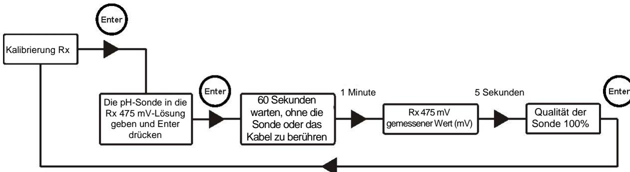
Am Ende des Verfahrens zeigt das Display die Qualität der kalibrierten Elektrode an. Sollte die Qualität der Sonde 25 % oder weniger betragen, eine neue Kalibrierung durchführen.
