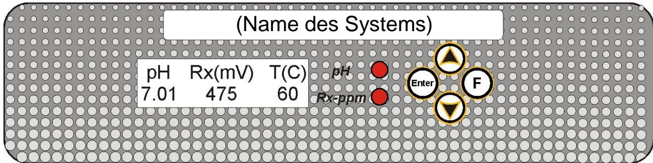
Die Programmierung des Systems Technopool pH-Rx ist in zwei Menüs unterteilt: **Benutzer** und **Installateur**.
