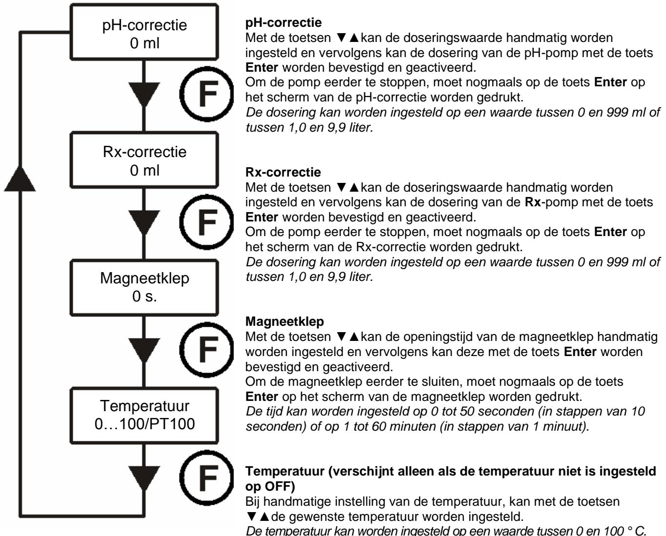
Om het priming-menu te verlaten moet de toets **F** drie seconden worden ingedrukt, of dit gebeurt automatisch als er gedurende een minuut niet op een toets is gedrukt.
