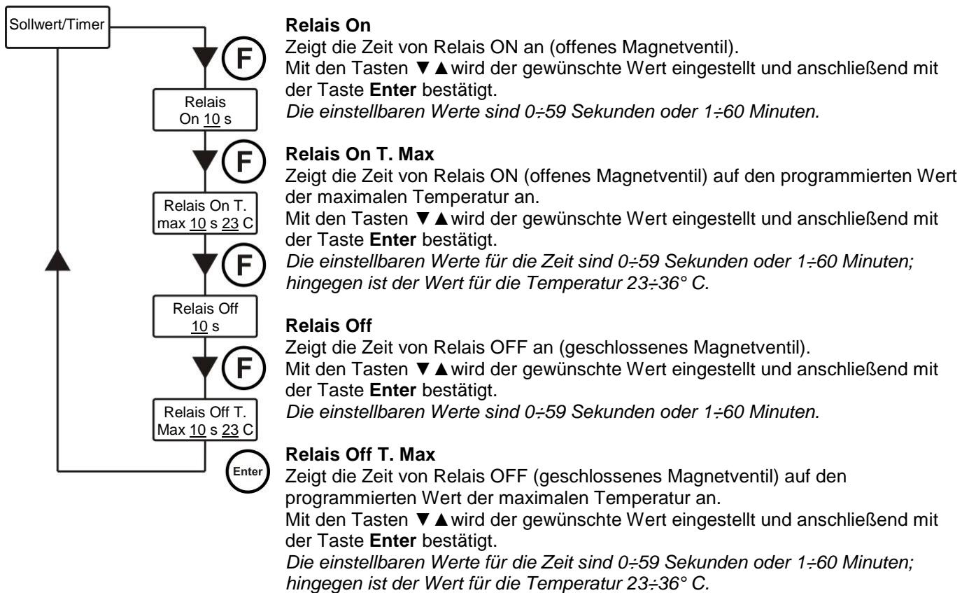
Die beiden Zeiten von ON und OFF sind proportional zur Temperatur, die während der letzten Dosierung gemäß dem nachstehend aufgeführten Schema erreicht wurde:
