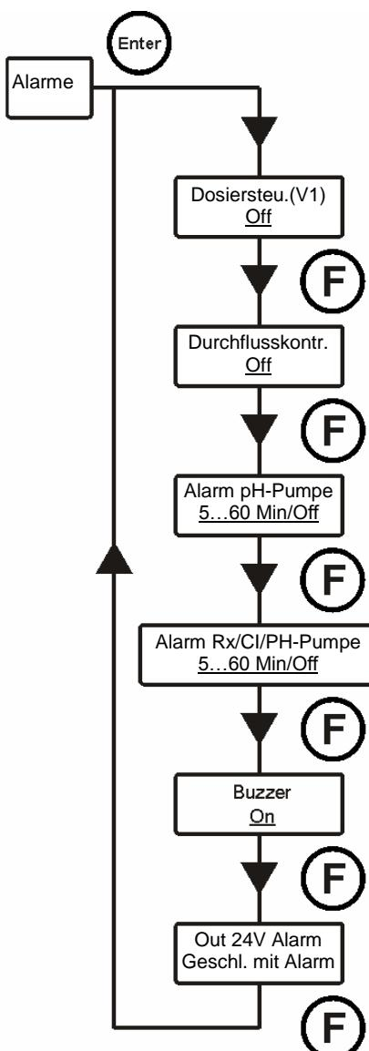
**Dosiersteuerung (V1).** Aktiviert oder deaktiviert die Freigabe der Dosierung bei Vorhandensein des Signals V1 (Signal der Umwälzungspumpe aktiv). Mit den Tasten  $\nabla \Delta$  wird zwischen den beiden Optionen gewählt und anschließend mit der Taste **Enter** bestätigt.
