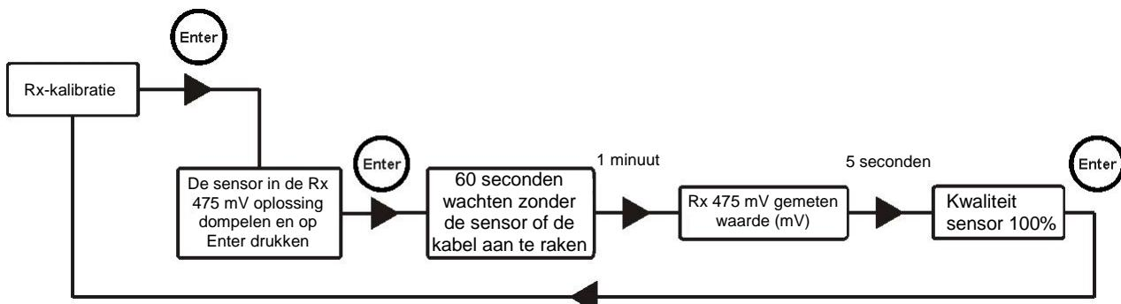
Na deze procedure geeft het scherm de kwaliteit van de gekalibreerde elektrode aan; als de kwaliteit van de sensor lager is dan 25%, moet een nieuwe kalibratie worden uitgevoerd.
