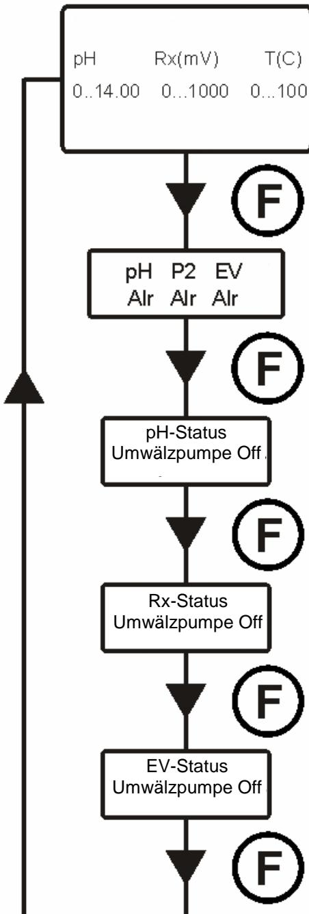
Der Default-Bildschirm zeigt die Erfassung der Sondenwerte des pH, des Redox und der Temperatur an.
