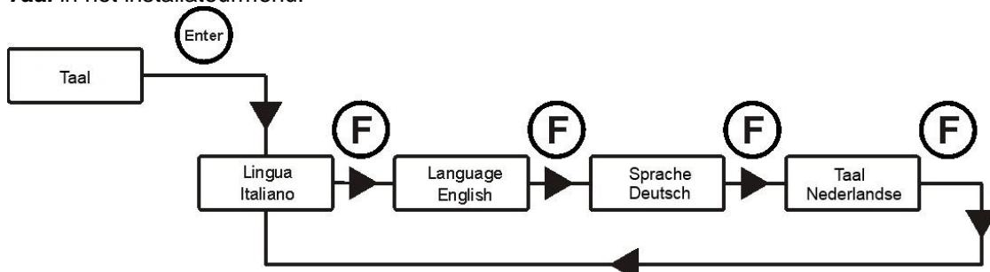
Om te bevestigen en af te sluiten moet de toets **Enter** drie seconden worden ingedrukt.
