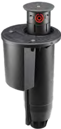
G-990C Aufsteigerhöhe: 8 cm Gesamthöhe: 34 cm Flanschdurchmesser: 19 cm Regneranschluss mit Innengewinde: 1½"-ACME (40 mm)
