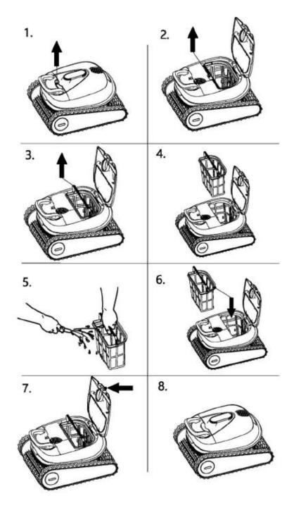
Vergewissern Sie sich, dass die Stromversorgung ausgeschaltet und der Netzstecker herausgezogen ist.
