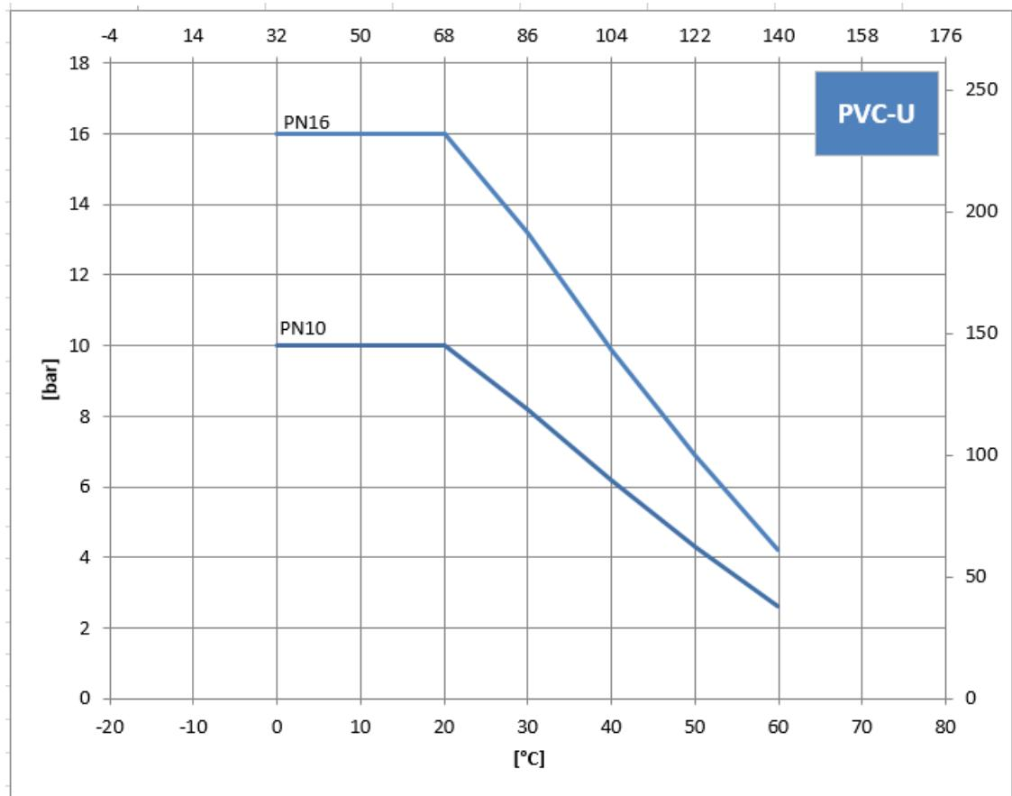
Das Druck – Temperatur – Diagramm basiert auf einem Sicherheitsfaktor von 2,5 und einer Lebensdauer von 25 Jahren
