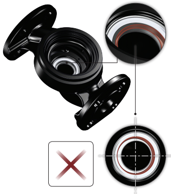
Nieprawidłowo wyśrodkowane uszczelnienie
